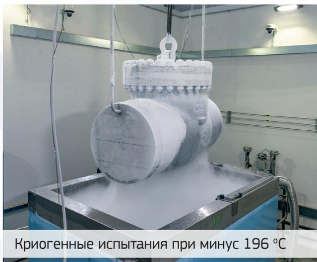
Криогенные испытания при минус 196 °С
